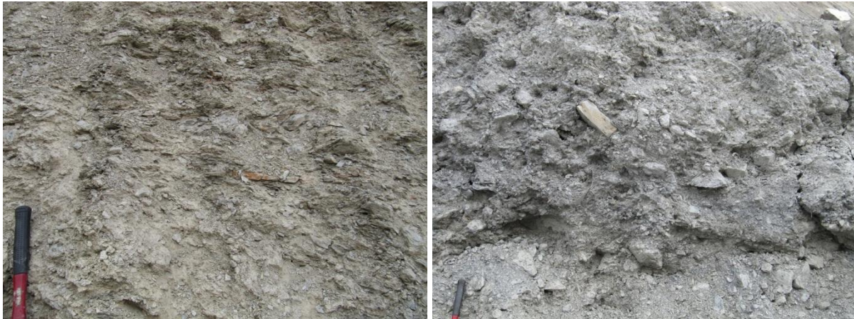
Рис. 46: Изображения выхода пород (молоток для сравнения масштаба), иллюстрирующие последовательность дезинтеграции от девственной породы (верхний слой) до полностью разрушенной массы камней, отложенной обломочным потоком. Вверху слева: Кальцитовый мрамор, частично доломитизированный; желтоватая поверхность породы в центре покрыта затвердевшей сбросовой глиной (катаклазитом). Вверху справа: Филлитовидный сланец, где большая часть кварца размером с мелкий песок или ил (вероятно, правильно его называть мета-силтит), слегка кальцифицированный, насыщенный кварцевыми жилами, вытянутыми в плоскости сланцеватости (наклон влево). Слева в середине: Кальцитовый/доломитный мрамор, как и выше, сильно раздробленный. Справа в середине: Как и ранее, полностью раздробленный, разлом проходит по картинке с верхнего левого угла в середину справа. Внизу слева: Дезинтегрированная масса камней, состоящая в основном из мрамора и фрагментов мета-песчаника/алеврита; слои волнистые ввиду ползучего движения склона. Внизу справа: Хаотическая масса камней, с фрагментами всех описанных видов пород, в песчаной матрице; при насыщении водой эта масса скорее потечёт вниз по склону, чем медленно сползёт.
