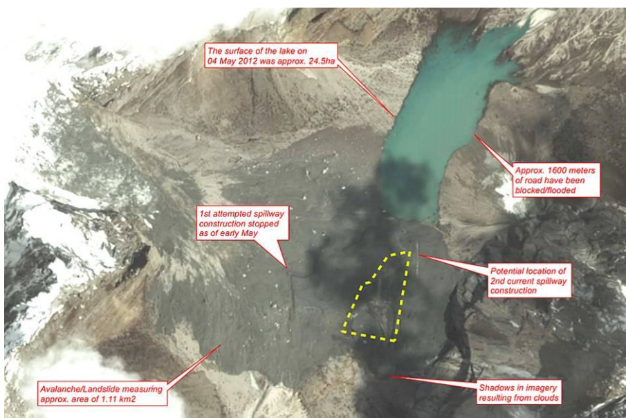
Рис. 13 – постер UNOSAT, используемый как основа для принятия решений. Лавина, начавшаяся в твёрдой области хребта Салторо в левой части снимка, увлекла за собой лёд с ледника и глину с окраинной морены на орографической правой стороне долины. Конус обломков/дамба и запруженное озеро хорошо видны на снимках после события. Изображения: Ikonos, 4 мая 2012.
