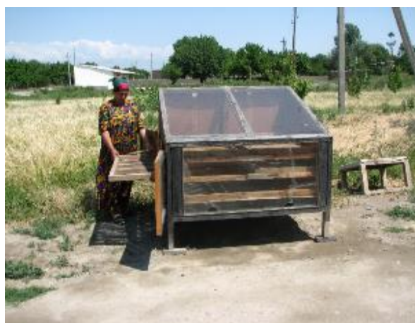
Рисунок 3. Сушилка абрикоса типа «горячий ящик» (по проекту MEDA). Вид сбоку и спереди.
