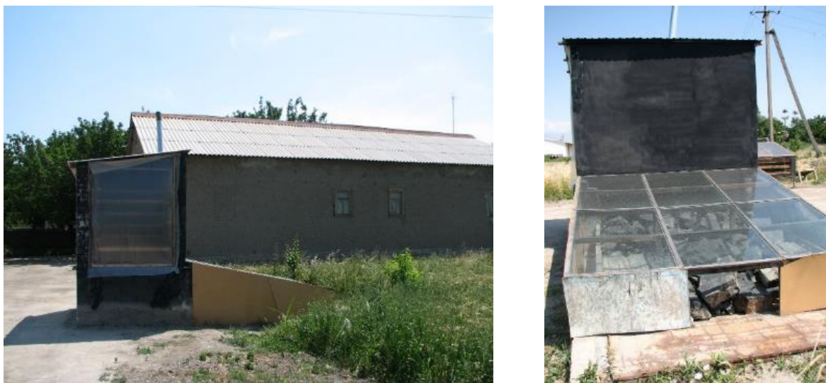
Рисунок 5. Солнечно-воздушная сушка в камерной теневой сушилке, Канибадамский район
