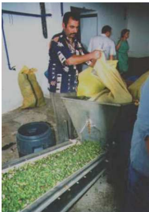
Расми 5. Халтаи калон ба фитаи конвейер барои калибргирӣ рехта мешавад. Марокко. Коргоҳи кавар.
